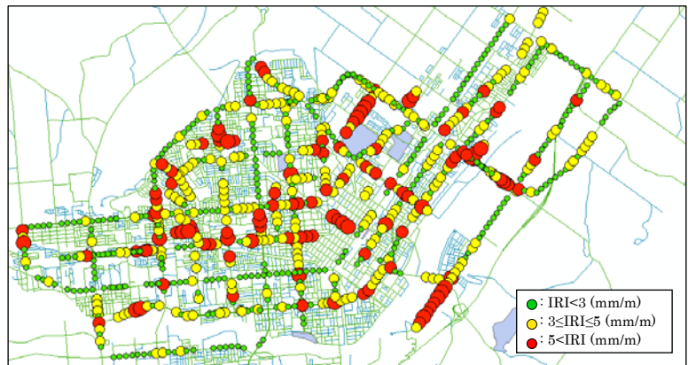
図-1 デジタル道路地図を用いた IRI 測定に基づく路面状態量の可視化結果：路線全体としての路面状態は良いが、局所的な平坦性の低下が確認でき、優先的に補修を必要とする箇所の判断ができる。
