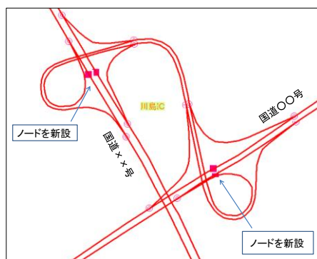
図-3 ICでのノード新設
