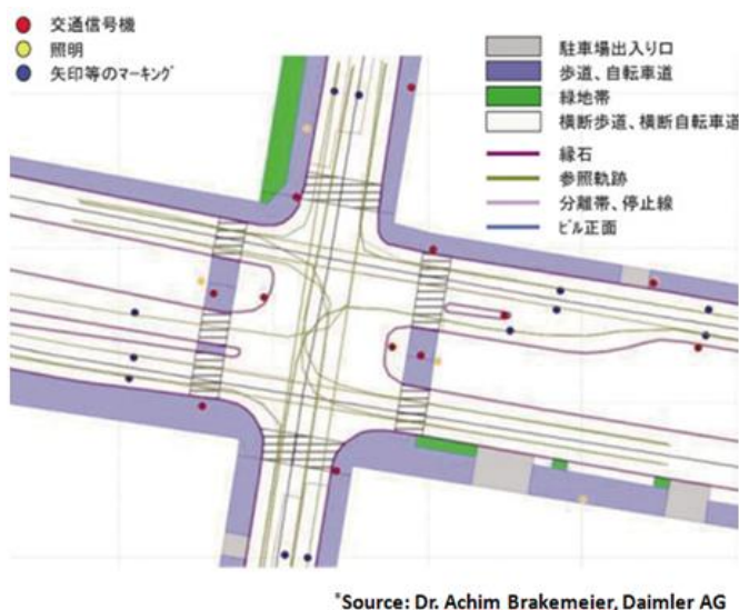
図-2 ローカルダイナミックマップのタイプ-1 & -2データの例
