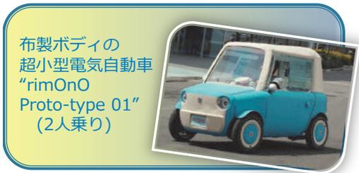
布製ボディの超小型電気自動車 “rimOnO Proto-type 01” (2人乗り)
