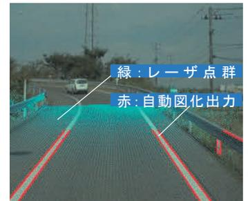
【図-5】自動図化→リアルタイム化
