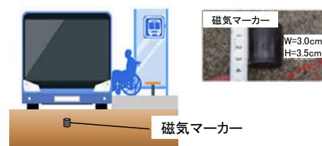
▲磁気マーカによる自車位置特定による運行の補助
