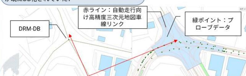
DRM-DBの交差点は25000レベル、一条線のネットワークデータであることから、一部で高精度三次元地図やプローブデータとズレが確認される。特に、変則的な交差点で顕著である。
